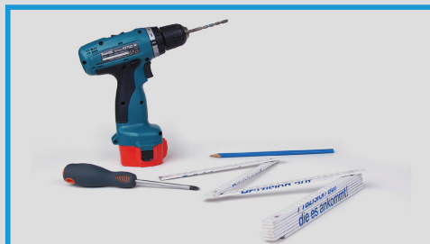
1) Potřebné nářadí Před začátkem práce zkontrolujte, že obkladový panel odpovídá svou velikostí formátu niky Pokud je třeba vyrobít výřez, postupujte nejprve podle návodu „Výřez pro elektroinstalaci“
