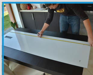
4) Spojnice mezi značkami v rozích rozdělte na stejné velké díly o max. rozteči 80cm a vyznačte zde další body
