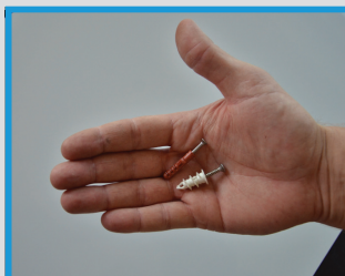
6) Součástí dodávky jsou hmoždinky do pevných materiálů (zdivo, beton, ytong/hebel, apod). Pokud instalujete obklad do sádkar-tonu, nebo podobného materiálu, zvolte speciální typ hmoždinek
